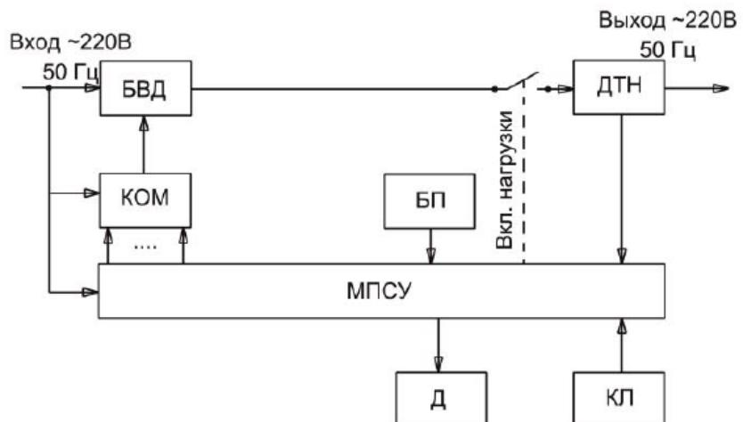
БВД – блок вольтодобавки; КОМ – коммутатор; МПСУ – микропроцессорная система управления; БП – блок питания; Д – дисплей цифровой; ДТН – датчик тока нагрузки; КЛ – клавиатура.
