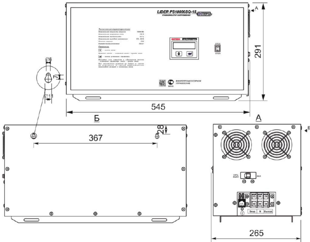
Габаритные и установочные размеры стабилизатора напряжения
